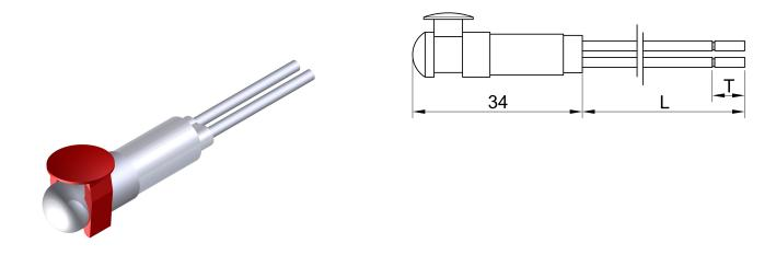
Lente inserita da fronte pannello si incastra con corpo segnalatore posizionato sul retro del pannello in corrispondenza della dima di foratura.
