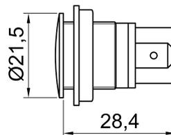
Segnalatore luminoso a LED SDM per foro da 18 mm con innesto da fronte pannello.
