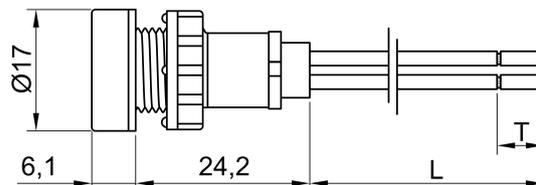
Segnalatore luminoso a LED SDM per foro da 12 mm con innesto da fronte pannello.
