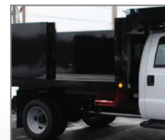
Side Swing Door 52" wide door 180° door swing 42" high sides
