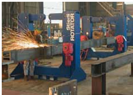
313 Einstellbare Arbeitshöhe + 2 Drehrichtungen Adjustable height and 2 turning directions
