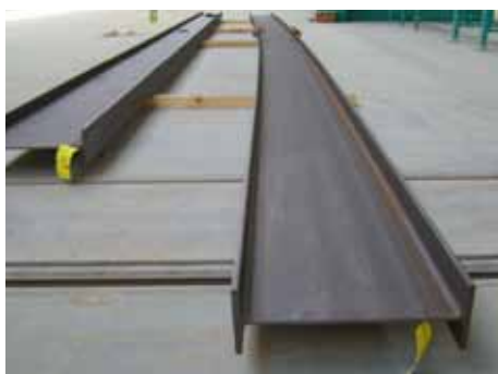
276 Biegen, Richten, Vorspannen (Überhöhen) Bending, straightening, cambering
