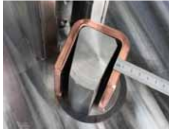
71 Enge Biegungen m. Sonderstempel Narrow section punch
