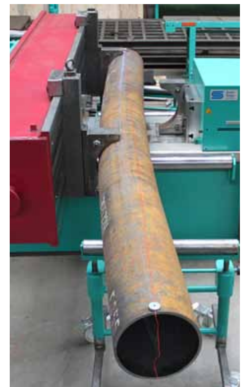
278 Rohre biegen bis ø400 mm Pipe bending up to ø400 mm
