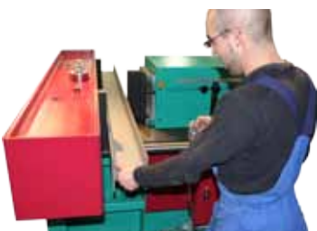
105 Richten mit Richtkabel Straightening with hand cable
