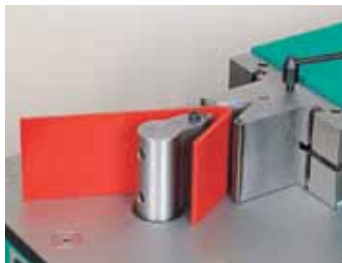
61 Biegen mit V-Prismen Bending with vee-block
