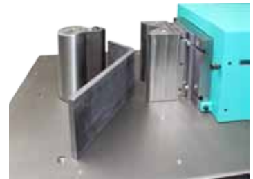
103 Biegen mit Biegeprisma Bending with V- Blocks
