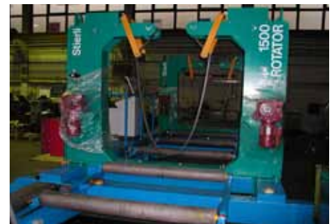
315 ROTATOR in Trägerschweissanlage integriert ROTATOR integrated in a beam line
