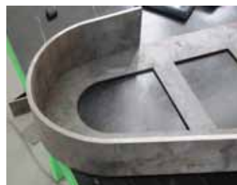
67 Biegen im "Step-Modus" Bending with "step-by-step"
