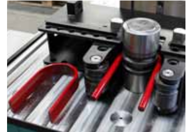
89 Horizontal biegen bis 180° Horizontal bending up to 180°
