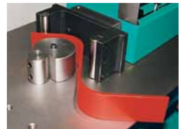
85 Biegen von grossen Radien Large radius bending
