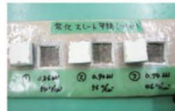
40年経過したスレートの引張り強度がJIS基準を大幅にクリアしています。
