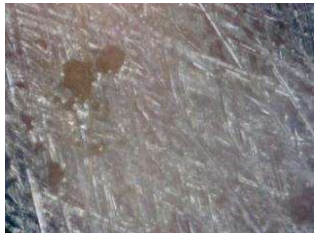
写真-10 孔食箇所 250 倍拡大写真
