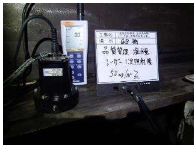
写真-4 レーザー照射後塩分測定
