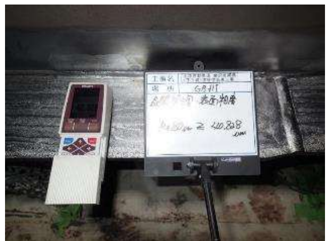
写真-5 レーザー照射後表面粗さ測定
