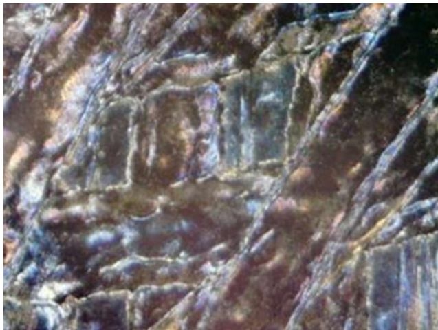
写真-7 レーザー照射後 250 倍拡大写真
