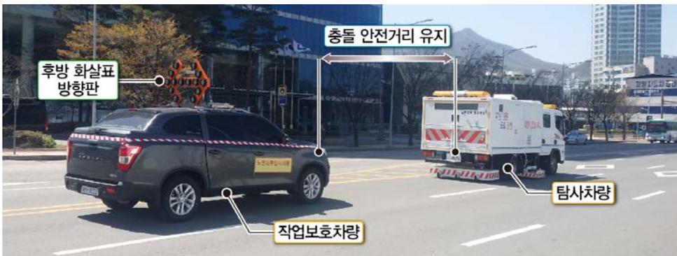
〈그림 3.10〉 작업보호자동차를 이용한 1차조사시 탐사전경
