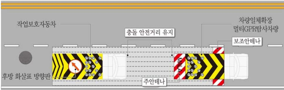
〈그림 3.9〉 작업보호자동차를 이용한 1차조사시 안전관리대책
