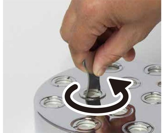
工具をリング溝に差し込み、**左回し**でリングを緩めます
