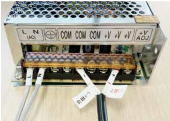
※プラス(+)とマイナス(-)に十分注意をして接続してください。間違えますと破損の原因になります。
