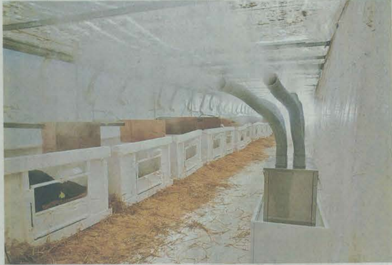
星光技研が開発した超音波噴霧器。除菌効果のある水溶液を噴霧する
