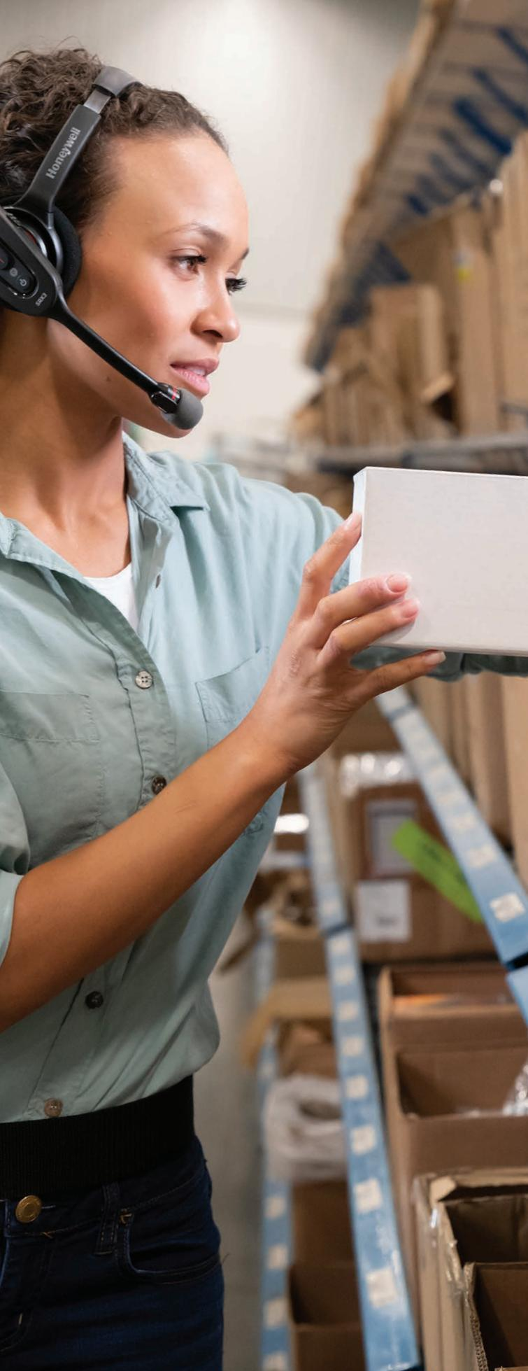
El operador del almacén porta un terminal en la cintura (talkman), la cual se complementa con una diadema con un auricular y un micrófono, para escuchar las instrucciones de cada tarea y confirmación de esta. El proceso de voice picking se divide en las siguientes etapas:
