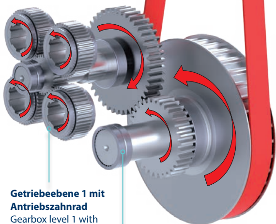
Getriebeebene 2 mit Zahnriemenscheibe, Ritzelwelle und Antriebsritzel Gearbox level 2 with timing belt disc, pinion shaft and driving pinion
