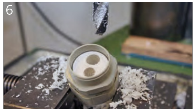
6 Zweite Bohrung in der Ansicht von unten
