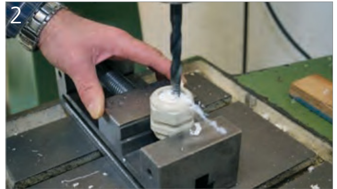
2 Bohrer an gewünschter Stelle positionieren. Bei geringer Drehzahl mit einem handelsüblichen HSS-Bohrer arbeiten.
