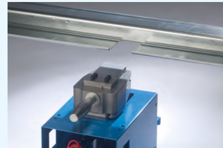
Ergebnis Auslinkprozess Result of the notching out process
