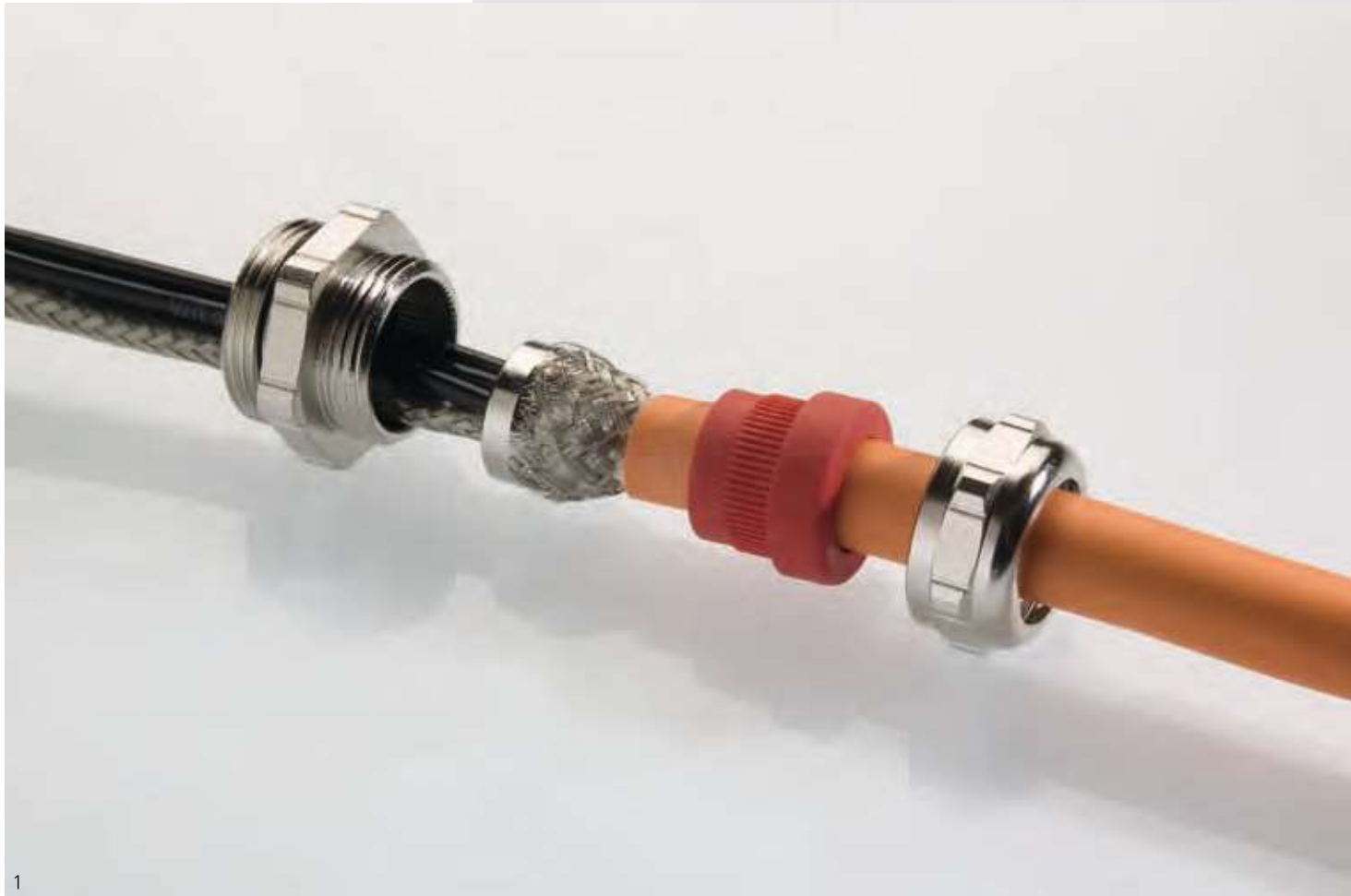
Abb. 1 – UNI Entstör Dicht – Schirmgeflecht liegt auf Konus auf. Fig. 1 – UNI Interference Suppression Dicht – braided shield on the
