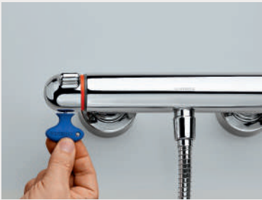
Gebruik de speciale Hansa sleutel om de instellingen aan te passen naar de thermische desinfectiemodus, duidelijk rood gemarkeerd
