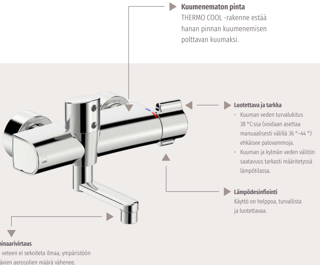
Thermo Cool -rakenne estää hanan pinnan kuumenemisen.
