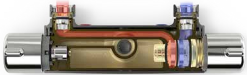
Thermo Cool -rakenne estää hanan pinnan kuumenemisen.
