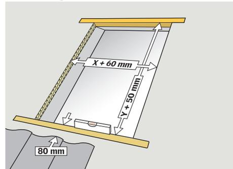
Tehnički otvor neophodan za pravilnu montažu krovnog prozora, trebalo bi da bude 60 mm širi i 50 mm duži od dimenzija krovnog prozora. Razmak između ugradne letve i vrha crepa treba da bude 80 mm.
