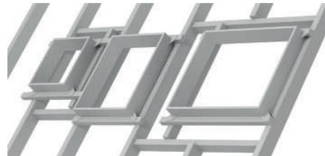
VELUX krovni prozori se proizvode u različitim standardnim dimenzijama i ugrađuju se u određena rastojanja između greda. Kada rastojanje između greda nije dovoljno, vrši se blago prilagođavanje postojećeg okvira, bez smanjenja snage i bezbednosti krova.
