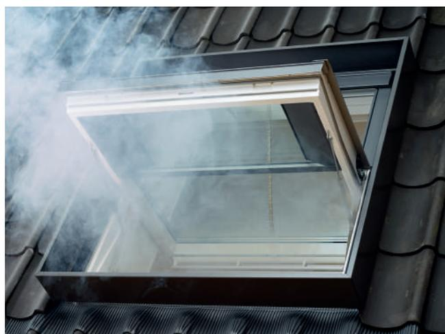
Sistem za odimljavanje u slučaju požara automatski otvara prozor i omogućava izlazak dima. Osim toga, prozor omogućava sve redovne funkcije prozora - dnevnu svetlost i provetravanje. Sistem je moguće spajati s protivpožarnim sistemima drugih proizvođača i testiran je u skladu s evropskim standardom EN 12101-2. Sastoji se od krovnog prozora i kontrolnog sistema za odimljavanje (KFX 210).
