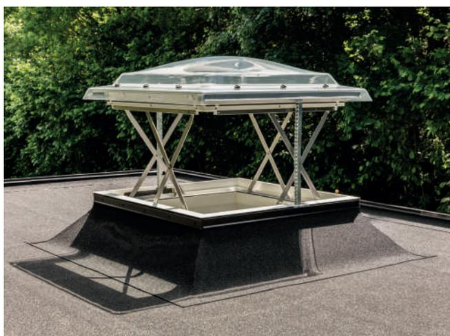
Sistem za odimljavanje u slučaju požara automatski otvara prozor i omogućava izlazak dima. Sistem je moguće spajati sa protivpožarnim sistemima drugih proizvođača i testiran je u skladu s evropskim standardom EN 12101-2. Sastoji se od prozora za ravan krov s akrilnom kupolom i integrisanim elektromotorom za otvaranje i kontrolnog sistema za odimljavanje.
