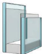
Dvostruko staklo - Energetski optimizovano dvostruko staklo sa  $U_w$  1,3. Spoljno kaljeno staklo za zaštitu od elementarnih nepogoda.
