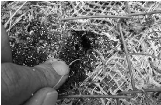
写真-43 緑化マットは通気性配慮もあり、 やや湿気に乏しい
