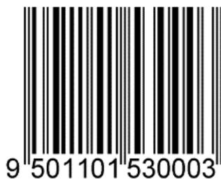
Los símbolos EAN/UPC contienen el GTIN, Los símbolos EAN/UPC se utilizan ampliamente en los puntos de venta al menudeo y no admiten la inclusión de atributos adicionales.
